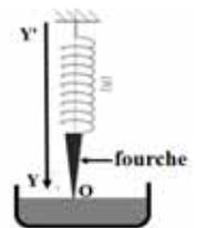
La célérité des ondes  $C=10\text{cm/s}$ ; on suppose qu'il n'y a ni réflexion ni amortissement de l'onde.
